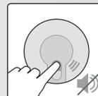
Stummschalt-Taste zur Unterdrückung des Alarmsignals
